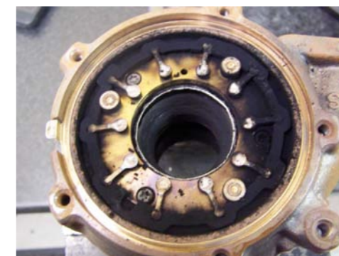
ZABLOKOWANY NAGAREM SYSTEM ZMIENNEJ GEOMETRII ŁOPATEK TURBOSPŘĘŻARKI
