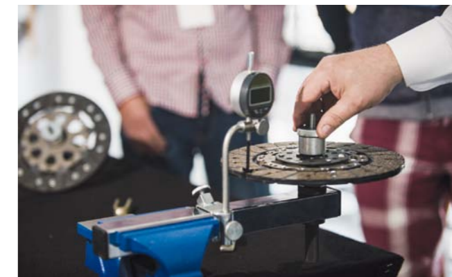
POMIAR BICIA TARCZY SPRZĘGŁOWEJ WERYFIKUJĄCY JEJ EKSPLOATACYJNĄ PRZYDATNOŚĆ
