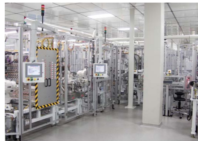
ZAUTOMATYZOWANE STANOWISKO MONTAŻU, SPAWANIA ORAZ TESTU WTRYSKIWACZA
