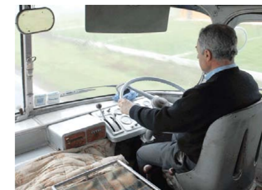
AUTOBUS FIAT 682 PRODUKOWANY W LATACH 60. ZESZŁEGO WIEKU PRZEZNACZONY DO RUCHU PRAWOSTRONNEGO MIAŁ KIEROWNICĘ PO PRAWIE STRONIE DLA UŁATWIENIA MANEWRÓW W CIĄSNYCH ZAUŁKACH
