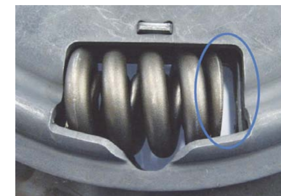
RYS. 7. KONSTRUKCJE WSPÓŁCZESNYCH WIELOSTOPNIOWYCH TŁUMIKÓW DRGAŃ SKRĘTNYCH W TARCZY SPRZĘGŁOWEJ CZĘSTO WYMAGAJĄ LUZU WSTĘPNEGO
