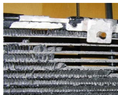
KOROZYJNE USZKODZENIE SKRAPLACZA (CHŁODNICY) KWALIFIKUJĄCE GO DO WYMIANY
