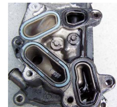
POMPA UKŁADU SMAROWANIA ZANIECZYSZCZONA CZĄSTKAMI WĘGLA
