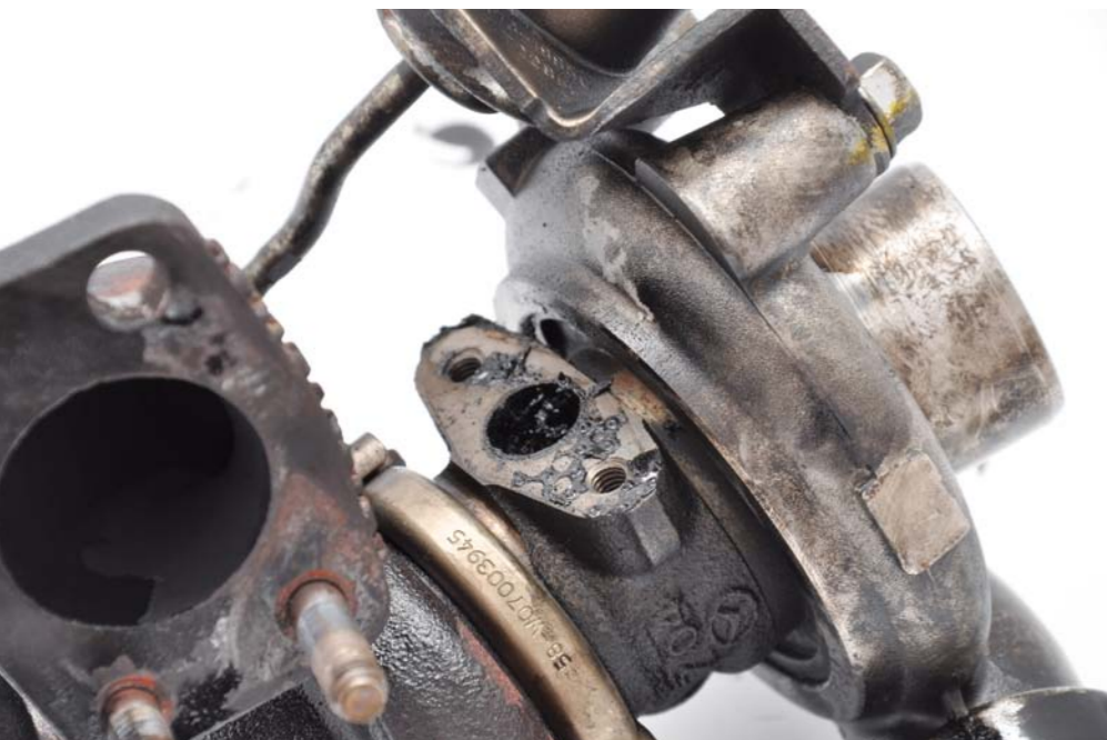
TURBOSPŘĘŻARKA WYMAGAJĄCA KOMPLEKSOWEJ WYMIANY
