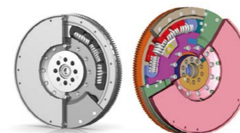
RYS. 4 I 5. W NAJNOWSZEJ GENERACJI TARCZ SPRZĘGŁOWYCH STOSUJE SIĘ NAJCZĘŚCIEJ TRZYSTOPNIOWY UKŁAD TŁUMIENIA DRGAŃ SKRĘTNYCH, ZAWIERAJĄCY TAKIE ELEMENTY, JAK: TARCZA ZABIERAKOWA, PRZECIWTARCZA ORAZ SPRĘŻYNY ŚRUBOWE O RÓŻNYCH STOPNIACH TŁUMIENIA (UMIĘJSCAWIANE W OKNACH ICH ŁOŻYSKOWANIA W OBUDWIE TARCZY SPRZĘGŁA)
