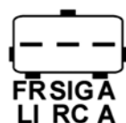
SCHEMAT ZŁĄCZA W ALTERNATORACH Z PORTEM FR-SIG-A
