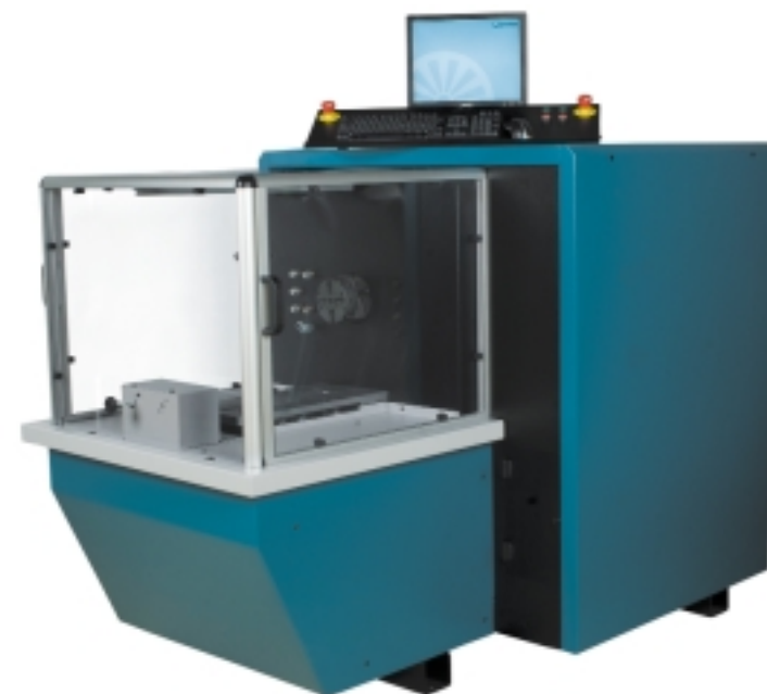
Urządzenie CR-p umożliwia badanie pomp wysokiego ciśnienia (do 2500 barów) w systemach common rail we wszystkich markach samochodów
