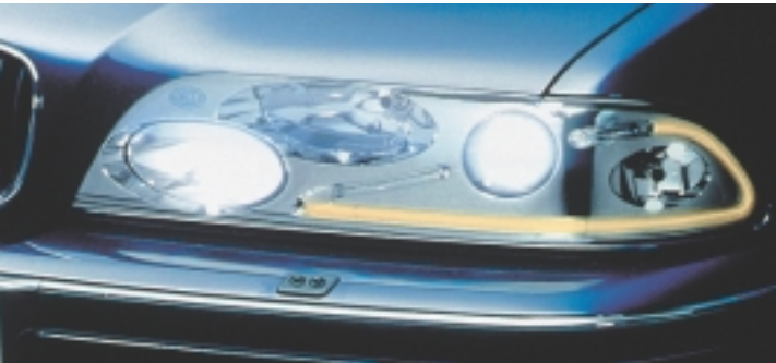
Pozycyjne lampy diodowe (z lewej) i światłowodowe dają nowe możliwości stylizacji nadwozia
