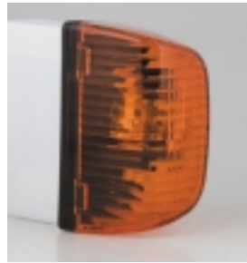
Światło wszelkich lamp sygnalizacyjnych powinno być rozpraszane przez klosz i ewentualnie też odbłyśnik
