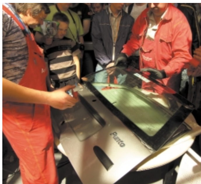
Jedna osoba przesuwając elektromagnes jak żelazko, po obwodzie szyby, a druga w tym czasie podważa krawędzie klinami. Cała operacja trwa kilka minut
