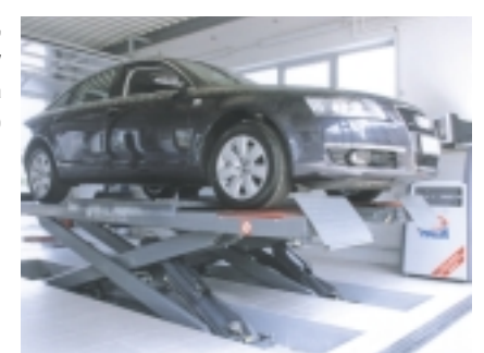
Przy diagnostyce podwozi pojazd musi stać na kołach, co umożliwiają podesty podnośników czterokolumnowych i nożycowych. Do odciążania zawieszonych dodatkowych dźwigników (dolne zdjęcie)
