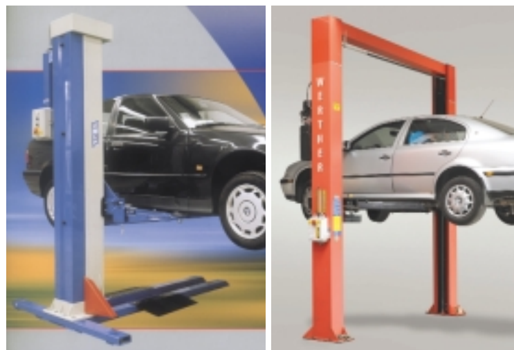
Konstrukcje jednokolumnowe, zwłaszcza mobilne (z lewej), zajmują mniej miejsca w warsztacie. Dwukolumnowe zapewniają lepszy dostęp do podwozi
