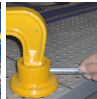
Wieloczęściowy zaczep do prostowania gniazd kolumn McPhersona. Najpierw łączy się tarcze oporowe z obu stron otworu, potem montuje hak, a do haka tańcuch ciągnący
