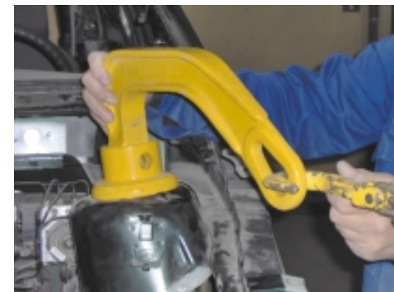
Wieloczęściowy zaczep do prostowania gniazd kolumn McPhersona. Najpierw łączy się tarcze oporowe z obu stron otworu, potem montuje hak, a do haka tańcuch ciągnący
