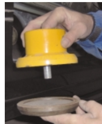
Wieloczęściowy zaczep do prostowania gniazd kolumn McPhersona. Najpierw łączy się tarcze oporowe z obu stron otworu, potem montuje hak, a do haka tańcuch ciągnący
