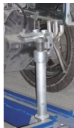
Blokowanie wyprostowanej już podłużnicy
