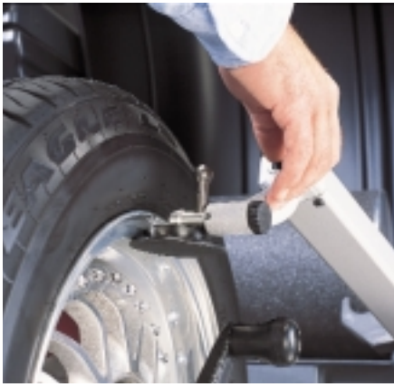
Z lewej: mechaniczne ramiona pomiarowe pozwalają wprowadzić parametry geometryczne do komputerowego sterownika bez pośrednictwa klawiatury Z prawej: zasada pomiarów bezdotykowych wykonywanych laserami lub sonarami
