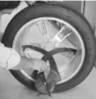
Do wstępnych pomiarów można użyć metrówki lub cyrkla warsztatowego, lecz wyniki obarczone są wówczas dużym błędem
