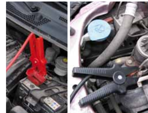
PRAWIDŁOWE PODŁĄCZENIE ZEWNĘTRZNEGO ŹRÓDŁA PRĄDU
