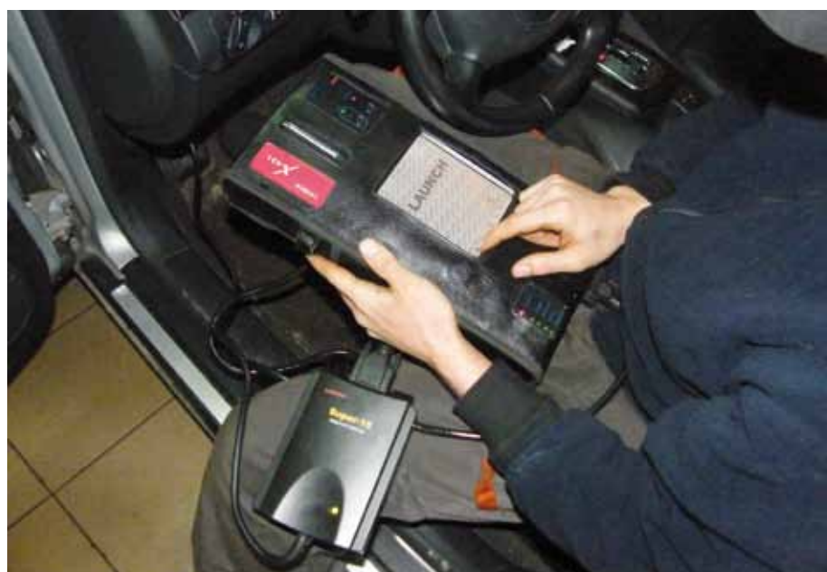
TESTER DIAGNOSTYCZNY X-431 PRZYDATNY PRZY OBSŁUDZE AUTOMATYCZNYCH SKRZYNI BIEGÓW
