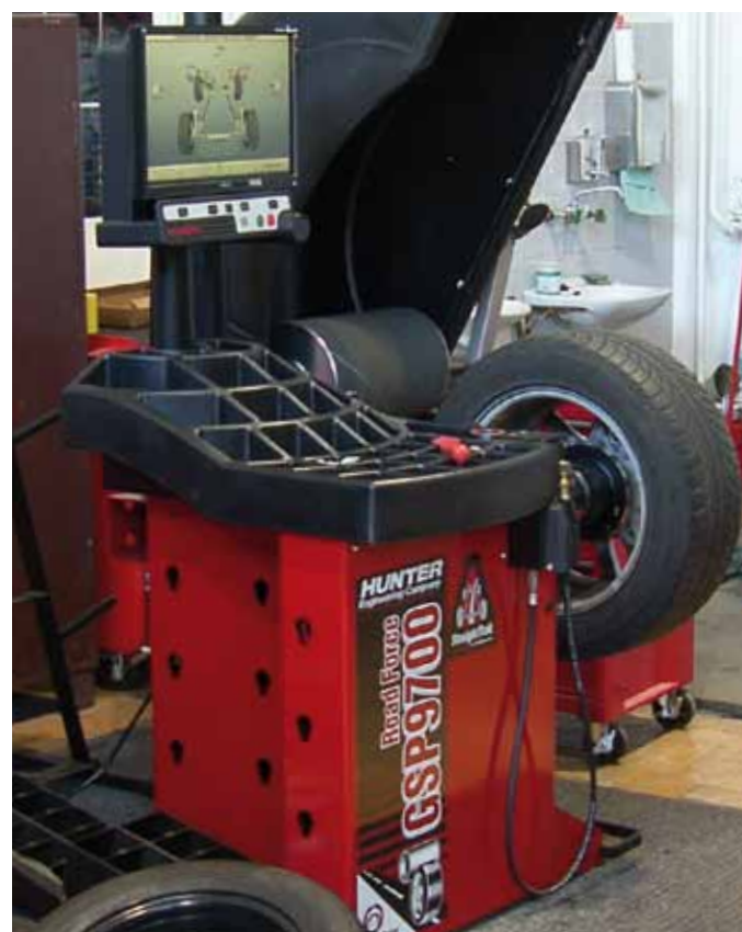
WYWAŻARKA HUNTER OBSŁUGUJĄCA SYSTEM TPMS
