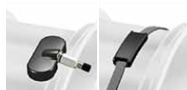
CZUJNIK ZINTEGROWANY Z ZAWOREM KOŁA (Z LEWEJ) I UMIESZCZONY NA TAŚMIE WEWNĄTRZ OBRĘCZY (Z PRAWYJ)
