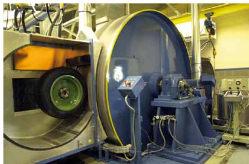
BADANIE DYNAMICZNE STANU OPONY PRZEZNACZONEJ DO BIEŻNIKOWANIA
