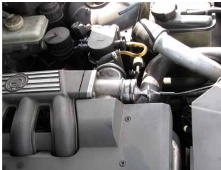
DYFUZOR Z APLIKATOREM DOCISKANY JEST DO KOLEKTORA SSĄCEGO WY- ŁĄCZNIE CIŚNIE- NIEM ATMOSFE- RYCZNYM
