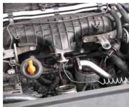
DYFUZOR Z APLIKATOREM DOCISKANY JEST DO KOLEKTORA SSĄCEGO WY- ŁĄCZNIE CIŚNIE- NIEM ATMOSFE- RYCZNYM
