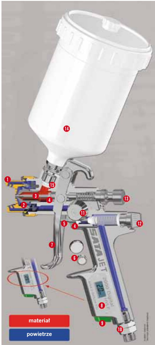
KONSTRUKCJA PISTOLETÓW HVLP I RP (TU SATAJET 2000) JEST NIEMAL IDENTYCZNA. RÓŻNICE DOTYCZĄ TYLKO PARAMETRÓW HYDRO- I AERODYNAMICZNYCH: 1. GŁOWICA Z NIKLOWANEGO BRĄZU, 2. DYSZA ROZPYLAJĄCA Z NIERDZEWNEJ STALI, 3. IGLICA Z NIERDZEWNEJ STALI, 4. SAMOREGULUJĄCE SIĘ DŁAWIKI, 5. TRZPIEŃ ZAWORU POWIETRZNEGO, 6. BATERIA ELEKTRONICZNEGO MANOMETRU, 7. JĘZYK SPUSTOWY, 8. MANOMETR CYFROWY, 9. KOLOROWY IDENTYFIKATOR PISTOLETU, 10. ZŁĄCZKA PNEUMATYCZNA, 11. REGULACJA PRZĘKROJU STRUMIENIA, 12. POKRĘTŁO REGULACJI PRZEPŁYWU POWIETRZA ZE SKALĄ, 13. REGULACJA PRZEPŁYWU MATERIAŁU, 14. ZBIORNIK LAKIERU, 15. FILTR SIATKOWY
