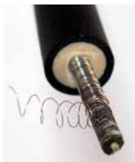
BUDOWA PRZEWODU FERRYTOWEGO (Z LEWEJ) I ZACHODZĄCY W NIM EFEKT ABSORPCJI
