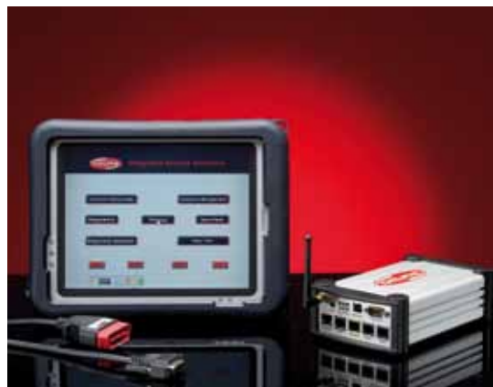
Z LEWEJ: ZESTAW URZĄDZEŃ DIAGNOSTYCZNYCH NA BAZIE KOMPUTERÓW TYPU TABLET PC, Z PRAWEJ: TESTER PDA STEROWANY Z KIESZONKOWEGO KOMPUTERA PC
