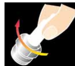
KOLEJNE (OD LEWEJ) FAZY WYMIANY ŚWIECY: ODKRĘCENIE KLUCZEM CZĘŚCI ZUŻYTEJ, RĘCZNE WKRĘCENIE NOWEJ, DOKRĘCENIE KLUCZEM RURKOWYM DO OPORU, A POTEM DYNAMOMETRYCZNYM DO ZADANEJ WARTOŚCI MOMENTU
