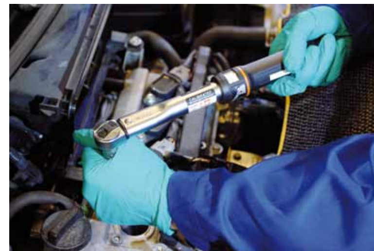
PRAWIDŁOWE UŻYCIIE KLUCZA DYNAMOMETRYCZNEGO Z OSIOWĄ PRZEDŁUŻKĄ NASADKI
