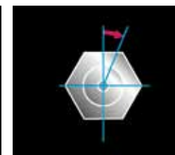
KOLEJNE (OD LEWEJ) FAZY WYMIANY ŚWIECY: ODKRĘCENIE KLUCZEM CZĘŚCI ZUŻYTEJ, RĘCZNE WKRĘCENIE NOWEJ, DOKRĘCENIE KLUCZEM RURKOWYM DO OPORU, A POTEM DYNAMOMETRYCZNYM DO ZADANEJ WARTOŚCI MOMENTU
