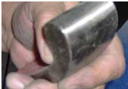
KLEPADŁO TYPU „COMA” DO PROSTOWANIA MAŁYCH WGNIECIEŃ WTRÓNYCH
