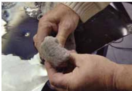
KLEPADŁO OWINIĘTE TKANINĄ PRZY PROSTOWANIU BLACHY ALUMINIOWEJ
