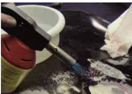
PALNIK GAZOWY UŻYWANY ZAMIAST ELEKTRODY (STRZAŁKA WSKAZUJE ŚLAD KREDKI)
