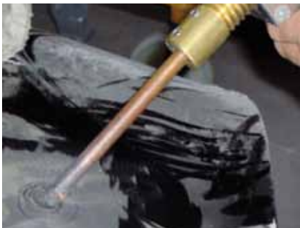
MIEJSCOWE NAGRZEWANIE ROZCIĄGNIĘTEGO MATERIAŁU ELEKTRODĄ WĘGLOWĄ
