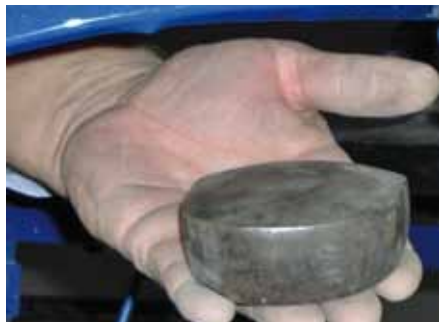
KLEPADŁO PRZYKŁADANE OD SPODU NA ŚRODKU ZAGŁĘBIENIA
