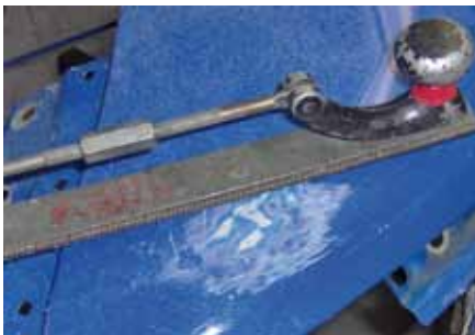
KONTROLA NAPRAWIONEJ STREFY PILNIKIEM BLACHARSKIM
