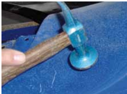
PIERWSZA FAZA PROSTOWANIA WGNIECENIA PO ZACIEŚNIANIU SPIRALI
