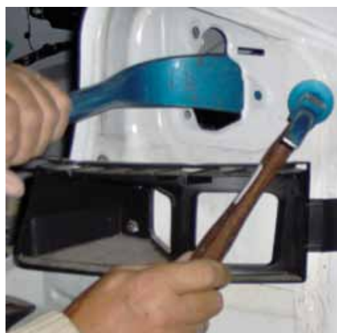
SPOSÓB UŻYCIA KLEPADŁA ŁYŻKOWEGO Z RĘKOJĘCIĄ WYGIĘTĄ (NA DOLNYM ZDJĘCIU WIDOK OD WNĘTRZA NADWOZIA)
