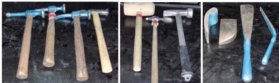
OD LEWEJ: MŁOTKI DO OBRÓBK BLACH STAŁOWYCH (OSTATNI TYPU „KARO”), MŁOTKI DO ALUMINIUM (DREWNIANY, NIERDZEWNY, ALUMINIOWY), KLEPADŁA („COMA”, STANDARDOWE Z RĘKOJĘCIĄ PROSTĄ I WYGIĘTĄ)
