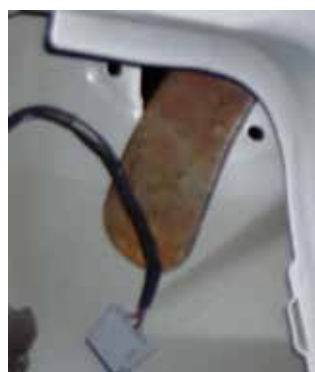
SPOSÓB UŻYCIA KLEPADŁA ŁYŻKOWEGO Z RĘKOJĘCIĄ WYGIĘTĄ (NA DOLNYM ZDJĘCIU WIDOK OD WNĘTRZA NADWOZIA)
