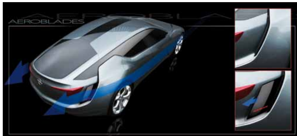
OPEL FLEXTREMA I JEGO AKTYWNA AERODYNAMIKA
