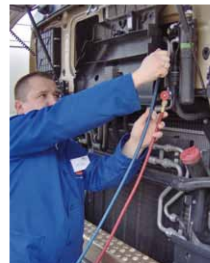
OBŚŁUGĘ DUŻYCH KLIMATYZATORÓW UŁATWIAJĄ DŁUGIE PRZEWODY I ZNAZNA POJEMNOŚĆ BUTLI
