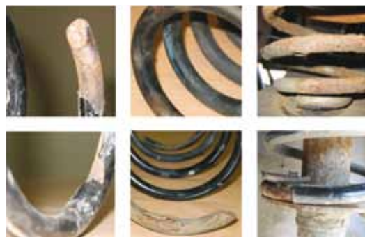
KOROZYJNE WŻERY NA POWIERZCHNI SPRĘŻYN SZYBKO POGŁĘBIAJĄ SIĘ, DOPROWADZAJĄC DO PĘKNIĘĆ
