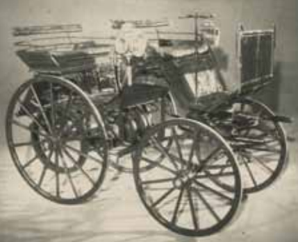
SILNIK UMIESZCZONY W BEZPOŚREDNIM SĄSIĘDZTWIE TYLNEJ NAPĘDZANEJ OSI TO ROZWIĄZANIE NAJPROSTSZE – POWSZECHNE W KONSTRUKCJACH PIONIERSKICH I NIEKIEDY TEŻ OPTYMALNE WSPÓŁCZEŚNIE (NA ZDJĘCIACH: DAIMLER Z ROKU 1886 I SMART)
