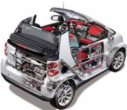
SILNIK UMIESZCZONY W BEZPOŚREDNIM SĄSIĘDZTWIE TYLNEJ NAPĘDZANEJ OSI TO ROZWIĄZANIE NAJPROSTSZE – POWSZECHNE W KONSTRUKCJACH PIONIERSKICH I NIEKIEDY TEŻ OPTYMALNE WSPÓŁCZEŚNIE (NA ZDJĘCIACH: DAIMLER Z ROKU 1886 I SMART)
