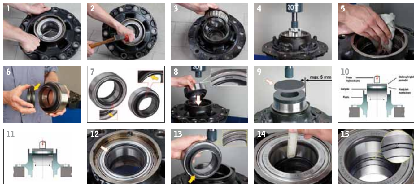
KOLEJNE FAZY WYMIANY ŁOŻYSK Z WYKORZYSTANIEM ZESTAWU NAPRAWCZEGO FAG
