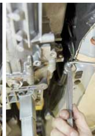
FOT. 1. ODEŁĄCZANIE PASKA UZIEMIAJĄCEGO ORAZ PRZEWODU HYDRAULICZNEGO WYSPRĘŻLIKA CSC
