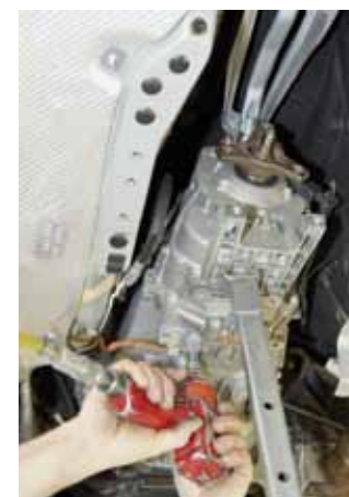
FOT. 1. ODEŁĄCZANIE PASKA UZIEMIAJĄCEGO ORAZ PRZEWODU HYDRAULICZNEGO WYSPRĘŻLIKA CSC
