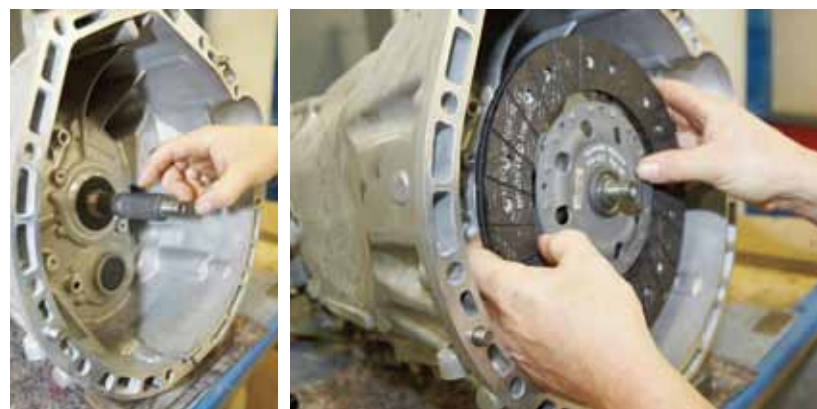
FOT. 6. SMAROWANIE WIELOKLINU WAŁU WEJŚCIOWEGO
