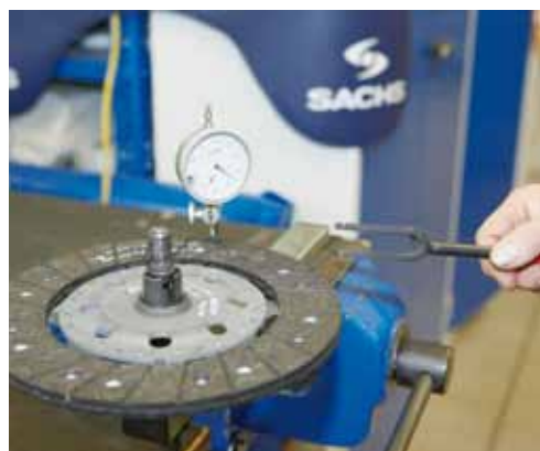
FOT. 5. KONTROLA BICIA POPRZECZNEGO TARCZY
