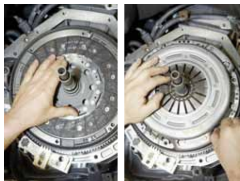
FOT. 7. INSTALACJA NOWEJ TARCZY ORAZ POKRYWY SPRZĘGŁA
