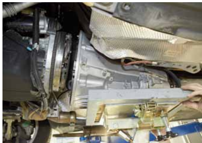
FOT. 3. DEMONTAŻ SKRZYNI BIEGÓW
