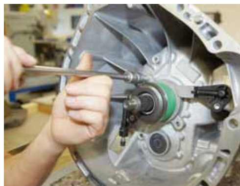
FOT. 8. INSTALACJA NOWEGO WYSPRZĘGLIKA CDC
