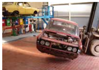
PO MECHANICZNYM DEMONTAŻU ZOSTAJE TYLKO SAMO NADWOZIE...
