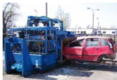
... KTÓRE TRZEBA ROZDROBNIĆ W MASZYNIE ZWANEJ SPTRZĘPIARKĄ
