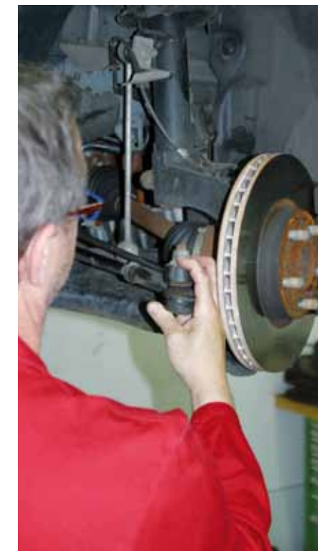
SPRAWDZANIE LUZU OSIOWEGO SWORZNIA
