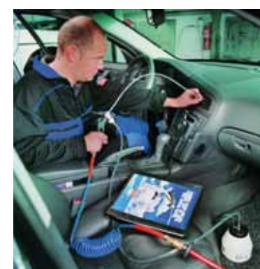
OD LEWEJ: APLIKOWANIE PREPARATU KLIMA-ANLAGEN-REINIGER ZA POMOCĄ RĘCZNEJ POMPKI; BIEŻĄCA DEZYNFEKCJA KANAŁÓW POWIETRZNYCH PREPARATEM KLIMA-FRESC; PRAWIDŁOWY ROZDZIAŁ NADMUCHU POWIETRZA W TRAKCIE DOKONYWANYCH ZABIEGÓW DEZYNFEKCYJNYCH
