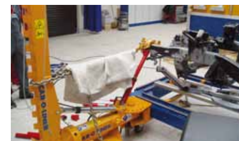
PROSTOWANIE SKRĘCENIA PRZEDNIEJ CZĘŚCI PODŁUŻNICY DOZEREM I WSPÓŁPRACUJĄCYM Z NIM HYDRAULICZNYM (CZERWONYM) ROZPIERACZEM
