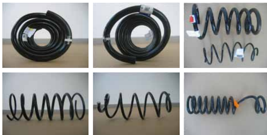
PRZYKŁADOWE RODZAJE ZWOJOWYCH SPRĘŻYN ZAWIESZEŃ: U GÓRY Z PRAWY: WERSJA SIDE LOAD
