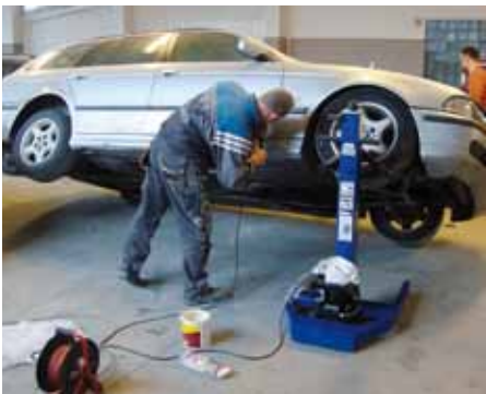
PODNOSZENIE ZA PRZEDNIE KOŁO POWODUJE SILNY PRZECHYŁ BOCZNY CAŁEGO POJAZDU
