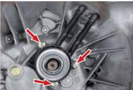
Montaż nowej części – moment dokręcania śrub 10 (+1) Nm
