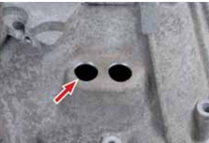
Stępanie krawędzi i czyszczenie wnętrza obudowy
