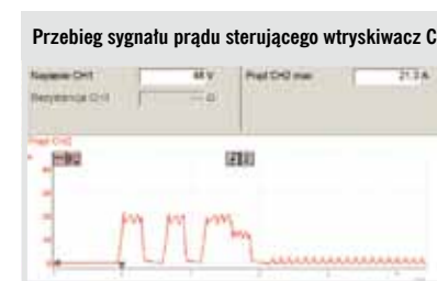
PRZEBIEGI OSCYLOSKOPOWE ZAREJESTROWANE PRZEZ DIAGNOSKOP FSA 740
