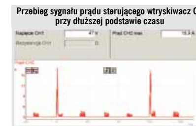
PRZEBIEGI OSCYLOSKOPOWE ZAREJESTROWANE PRZEZ DIAGNOSKOP FSA 740
