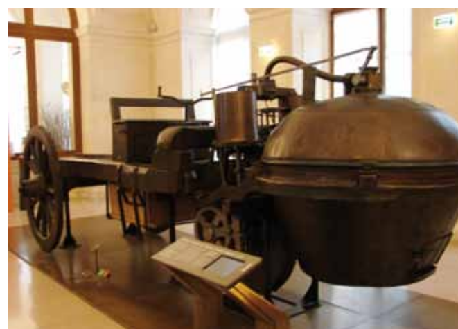
MIEDZIANY KOCIOŁ POJAZDU CUGNOTA ROZGRZEWANY BYŁ NAD OGNISKIEM. NIKT WTEDY NIE ZWRACAŁ UWAGI NA ILOŚĆ I SKŁAD WYDZIELANYCH PRZEZ TE KONSTRUKCJE SPALIN, DZIŚ WIELKIE AGLOMERACJE ZASNUWA SPALINOWY SMOG...
