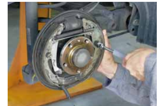
UŻYCIĘ SPECJALNEGO NARZĘDZIA DO OBSŁUGI POPRZECZNEGO MOCOWANIA SZCZĘK
