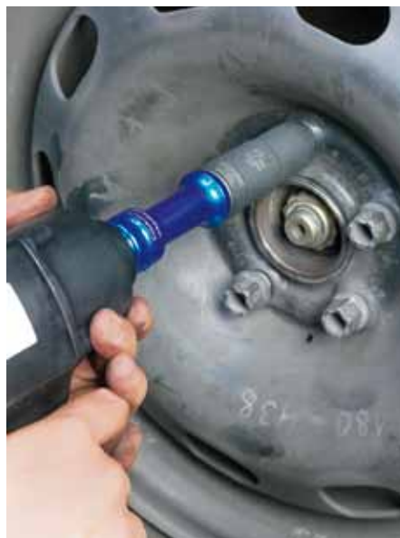
PRZY DOKRĘCANIU KÓŁ KLUCZEM PNEUMATYCZNYM OGRANICZNIK MOMENTU POWINIEN BYĆ TAK USTAWIONY, BY UMOŻLIWIĆ NASTĘPNIŁE PRECYZYJNE DOKRĘCENIE KLUCZEM DYNAMOMETRYCZNYM
