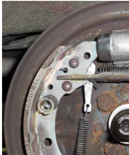
SPRAWDZENIA WYMAGAJĄ: STOPIEŃ ZUŻYCIA I EWENTUALNE USZKODZENIA AUTOMATYCZNEJ REGULACJI SZCZĘK
