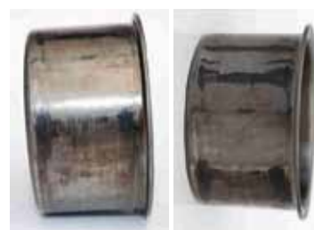
TERMICZNE PRZEBARWIENIA NA POWIERZCHNI KOŁA PASOWEGO NAPINACZA (Z LEWEJ) I ŚLADY STOPIONEJ GUMY NA KOŁE PASOWYM
