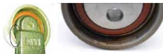
ZAKLESZCZENIE NAPINACZA NA SKUTEK BŁĘDNEJ REGULACJI (Z LEWEJ) I SKUTKI TEGO BŁĘDU
