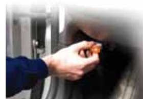
SPOSÓB INSTALACJI OBD LOG W POJEŹDZIE
