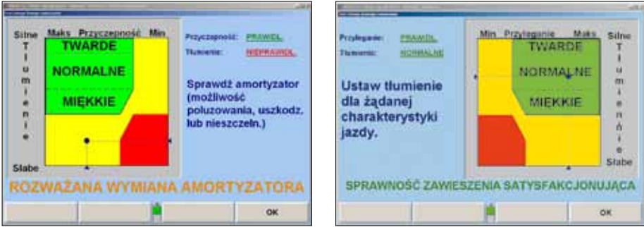
RYS. 4. WYNIKI TESTÓW TYLNEGO LEWEGO I TYLNEGO PRAWEGO ZAWIEŚZENIA W SAMOCHODZIE SUV
