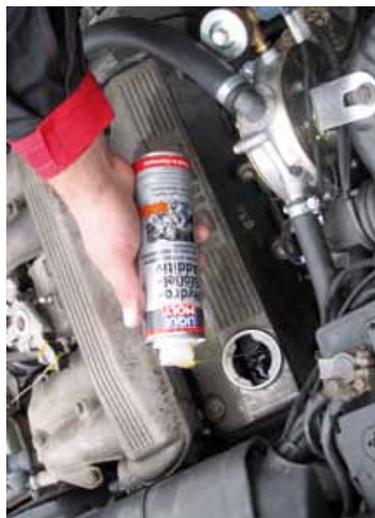
APLIKACJA PREPARATU REGENERUJĄCEGO HYDRAULICZNE POPYCHACZE ZAWORÓW
