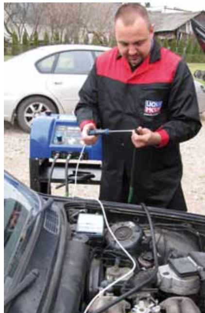
CZYSZCZENIE UKŁADU WTRYSKOWEGO I TŁOKOWO-KORBOWEGO
