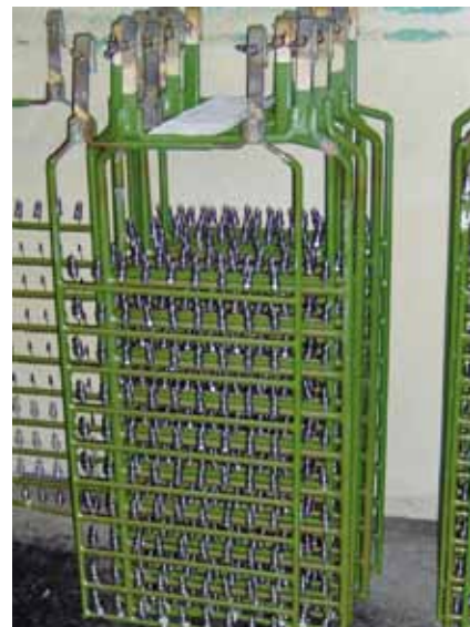
KORPUSY WYTRAWIONE KWASEM OCZEKIJĄ NA GALWANICZNE NIKLOWANIE
