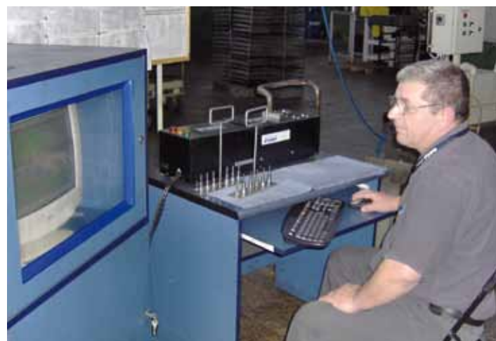
LASEROWO-KOMPUTEROWA KONTROLA ZGODNOŚCI WYMIARÓW Z PROJEKTEM
