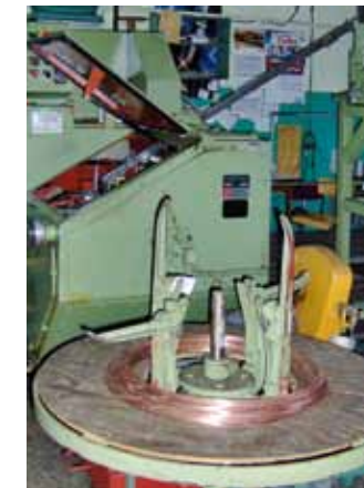
MASZYNOWE OSADZANIE MIEDZIANYCH RDZENI W STALOWYCH ELEKTRODACH
