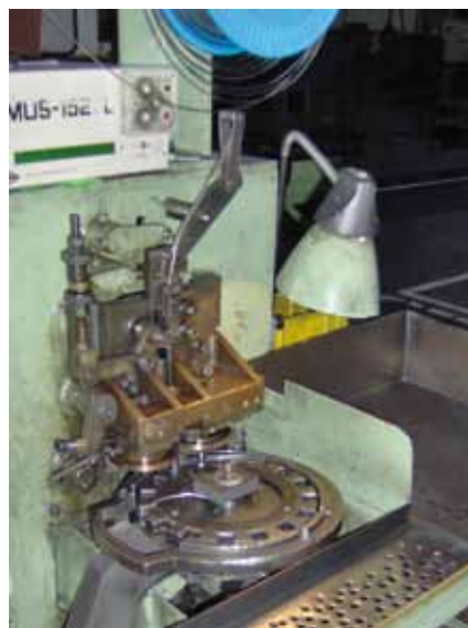
AUTOMATYCZNA SPAWARKA DO ŁĄCZENIA ELEKTROD BOCZNYCH Z KORPUSEM
