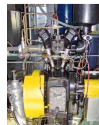
WZORCOWY SILNIK DO LABORATORYJNEGO TESTOWANIA ŚWIEC ZAPŁONOWYCH
