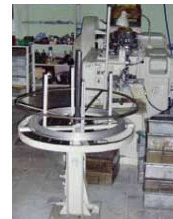
MASZYNOWE OSADZANIE MIEDZIANYCH RDZENI W STALOWYCH ELEKTRODACH
