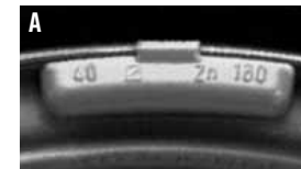
CIĘŻAREK STALOWY POWLEKANY BEZ ŚLADÓW KOROZJI (A) I Z JEJ ŚLADAMI (B)
