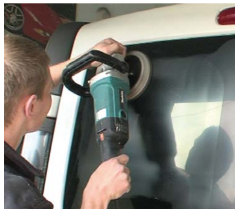
ZMATOWIENIA I PŁYTKIE UBYTKI MOŻNA NIWELOWAĆ METODĄ POLEROWANIA
