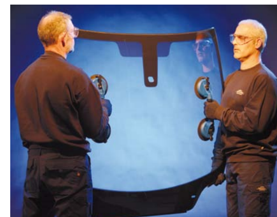
UCHWYTY PODCIŚNIENIOWE UMOŻLIWIAJĄ TEŻ BEZPIECZNY TRANSPORT SZYB W OBRĘBIE ZAKŁADU
