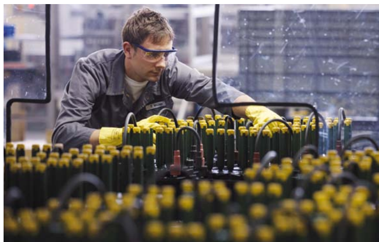
PIERWSZE (TZW. FORMUJĄCE) ŁADOWANIE AKUMULATORÓW PO NASĄCZENIU ICH SEPARATORÓW ELEKTROLITEM
