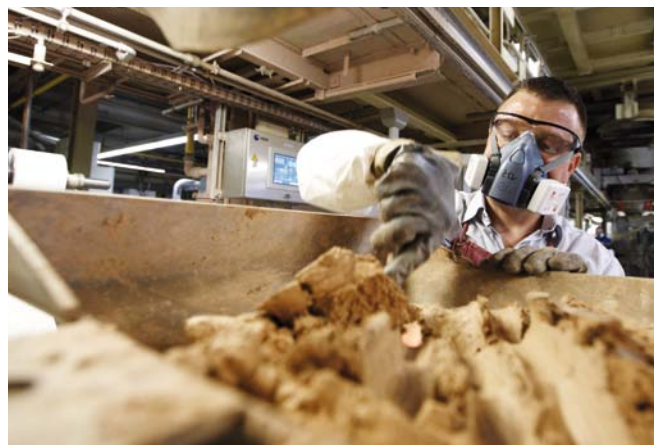
LINIA PRZYGOTOWYWANIA TZW. MASY CZYNNEJ DO WYPEŁNIANIA KRATEK ELEKTROD
