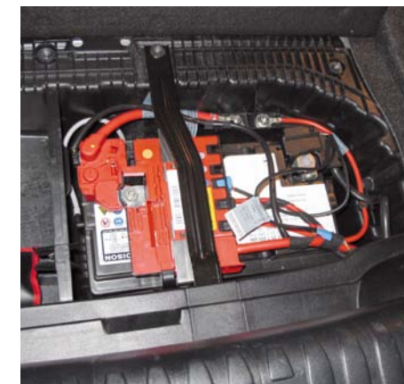
AKUMULATOR WYPOSAŻONY W ELEKTRONICZNY MODUŁ KONTROLNO-STERUJĄCY I WSPÓŁPRACUJĄCY Z SYSTEMEM START-STOP
