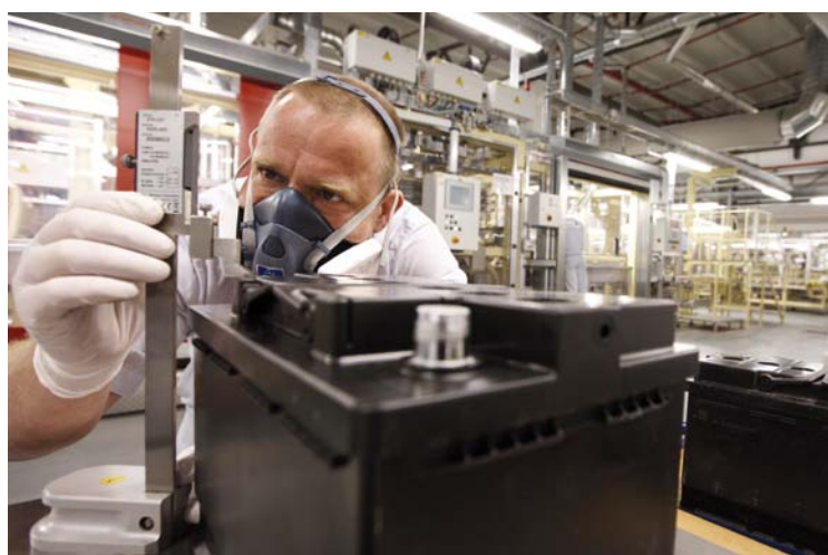
STANOWISKO OSTATECZNEJ KONTROLI WYMIARÓW ZEWNĘTRZNYCH ZMONTOWANEGO AKUMULATORA
