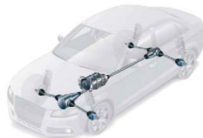
PRZEGUBY I PÓŁOSIE W SAMOCHODZIE Z NAPĘDEM 4X4
