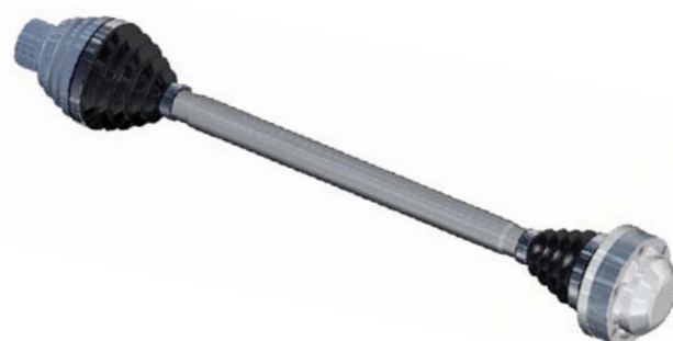
KOMPLETNA PÓŁOŚ Z PARĄ KONSTRUKCYJNIE ZRÓŻNICOWANYCH PRZEGUBÓW
