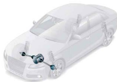
USYTUOWANIE PRZEGUBÓW W STANDARDOWYM WSPÓŁCZESNYM SAMOCHODZIE OSOBOWYM
