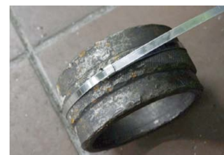
PO OPASANIU DOWOLNEJ KRAWĘDZI GUMOWEJ OSŁONY TAŚMĄ NAPINA SIĘ WSTĘPNIE, PRZECIĄGAJĄC JEJ DRUGI KONIEC PRZEZ SZCZELINĘ ZŁĄCZKI
