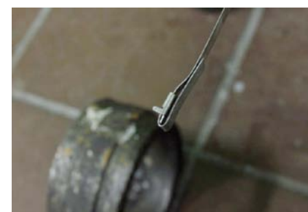
KONIEC UNIWERSALNEJ STAŁOWEJ TAŚMY PO WSUNIĘCIU GO W SPECJALNĄ ZŁĄCZKĘ TRZEBA ZAGIĄĆ POD KĄTEM 180° DO WNETRZA JEJ KRZYWIZNY
