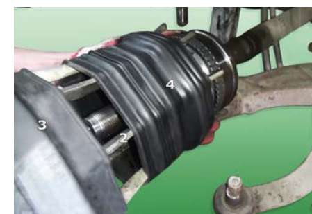
SPRĘŻYSCIE ROZCIĄGNIĘTA OSŁONA DAJE SIĘ BEZ TRUDU PRZESUNĄĆ PRZEZ ZAMONTOWANY JUŻ PRZEGUB DO SWOJEJ WŁAŚCIWEJ POZYCJI ROBOCZEJ
