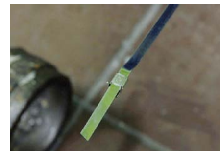
OBIE KRAWĘDZIE OSŁONY MOŻNA MOCOWAĆ CIĘTymi OPASKAMI ZACISKOWYMI, W SPOSÓB POKAZANY TUTAJ NA ZASTĘPCZYM MODELU
