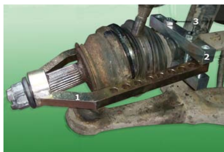
SZCZĘKI UCHWYTU ŚCIĄGACZA ZACISKA SIĘ ŚRUBAMI NA WALE PÓŁOSI PO PRZESUNIĘCIU GWINTOWANEJ KOŃCÓWKI PRZEGUBU PRZEZ PIERŚCIEŃ OPOROWY
