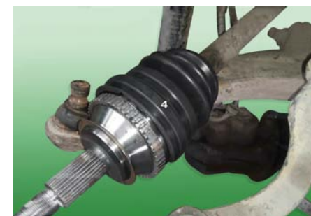
PRZED NASUNIĘCIEM KRAWĘDZI OSŁONY NA KOŁNIERZ PRZEGUBU TRZEBA WPROWADZIĆ DO JEJ WNETRZA ODPOWIEDNIĄ ILOŚĆ WŁAŚCIWEGO SMARU
