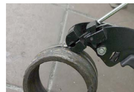
SPECJALNE KLESZCZE NAPĘŻAJĄ OPASKĘ Z WYMAGANĄ SIŁĄ I RÓWNOCZEŚNIE ZAGINAJĄ JĄ PRZY ZŁĄCZCE POD KĄTEM 90°, ZAMYKAJĄC OBWÓD
