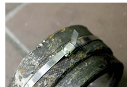
PROSTOPADLE ODGIĘTY KONIEC OPASKI WYMAGA JESZCZE ZAWINIĘCIA NA ZŁĄCZKĘ I ZABEZPIECZENIA ZA POMOCĄ JEJ BOCZNYCH WYPUSTEK
