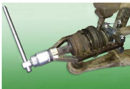
W TEJ KONSTRUKCJI ŚCIĄGACZA ROLĘ ŚRUBY POCIĄGOWEJ PEŁNI Z POWODZENIEM GWINTOWANA KOŃCÓWKI PRZEGUBU WRAZ Z JEJ ORYGINALNĄ NAKRĘTKĄ
