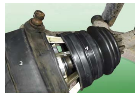
SPUSZCZENIE SPRĘŻONEGO POWIETRZA Z PNEUMATYCZNEGO SIŁOWNIKA POWODUJE ZAMKNIĘCIE RAMION I UMOŻLIWIA WYJĘCIE PRZYRZĄDU Z OSŁONY
