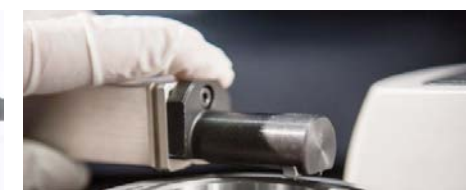
BADANIE CHROPOWATOŚCI POWIERZCHNI ELEMENTU
