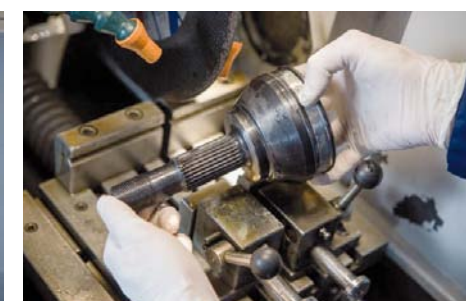
MOCOWANIE PRZEGUBU W IMAKU KOMPUTEROWEJ PRZECINARKI
