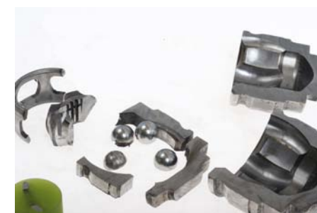
CIĘCIE PRZEGUBU NA PRÓBKĘ PODDAWANĄ BADAANIOM LABORATORYJNYM
