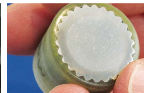
PRÓBKA METALU PO OSADZENIU W SPECJALNEJ ŻYWICY I OSZLIFOWANIU POWIERZCHNI PRZYGOTOWANA DO ANALIZY METALOGRAFICZNEJ. WIDOCZNE UTWARDZENIE POWIERZCHNIOWE
