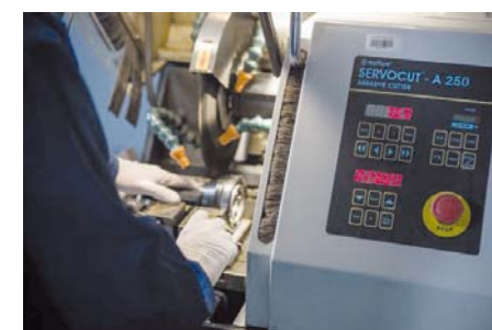
CIĘCIE PRZEGUBU NA PRÓBKĘ PODDAWANĄ BADAANIOM LABORATORYJNYM
