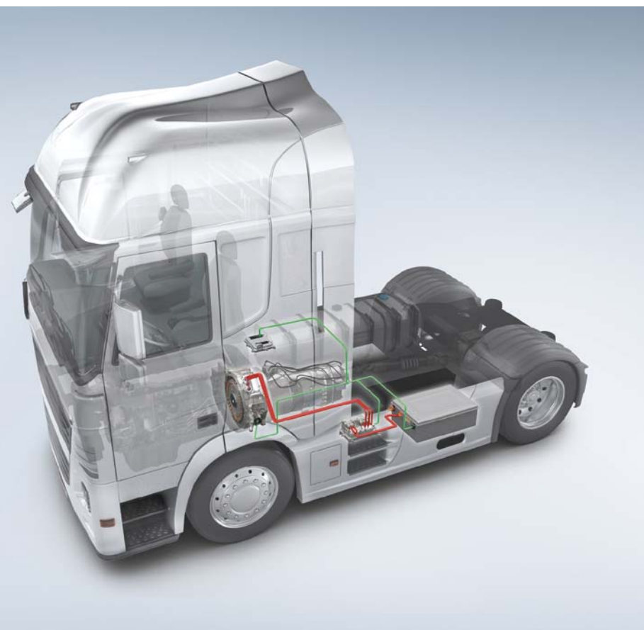
KONCEPCJA ZAMIANY CIEPŁA Z UKŁADU WYDECHOWEGO NA ENERGIĘ ELEKTRYCZNĄ LUB MECHANICZNĄ DAJE OK. 5 PROCENT OSZCZĘDNOŚCI PALIWA
